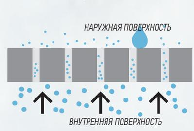
Капли влаги    Молекулы водяного пара    Поглощающий воду полиэфир    Водоотталкивающий полиэстер    Поры    С содержанием PTFE
