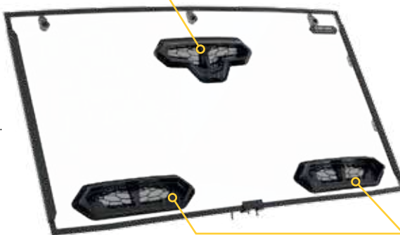
НИЖНИЕ ВЕНТИЛЯЦИОННЫЕ ОТВЕРСТИЯ ПОМОГАЮТ УСТРАНИТЬ ЗАПОТЕВАНИЕ ВЕТРОВОГО СТЕКЛА
